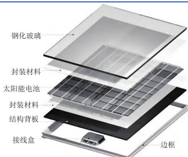
图表34: 光伏组件结构示意图
