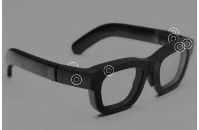
图表41: Meta Orion 的七个微型摄像头和传感器嵌入镜框边缘
