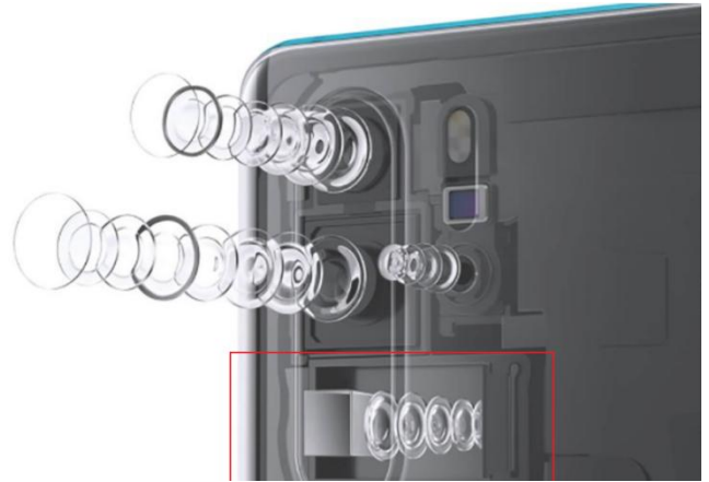
图表24: 华为 P30 系列的镜头组结构图
