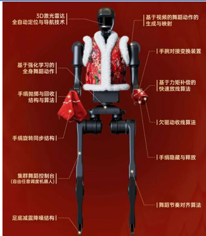
图表66: Unitree H1 头部搭载 3D 激光雷达
