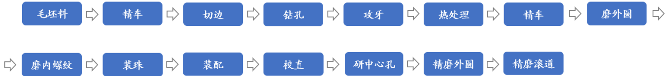
图表10: 滚珠丝杠-螺母部分工序图
