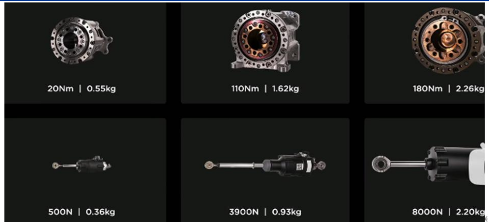
图表19: 特斯拉在 AI DAY 展示的 Optimus 旋转执行器与线性执行器
