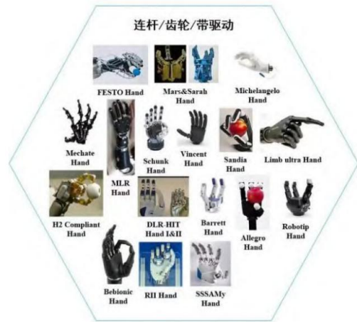
图表16: 连杆/齿轮/带传动灵巧手
