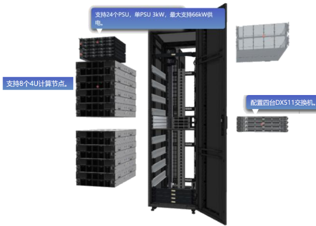
图表7: Atlas 900 A2 PoD 集群基础单元爆炸图 (1)
