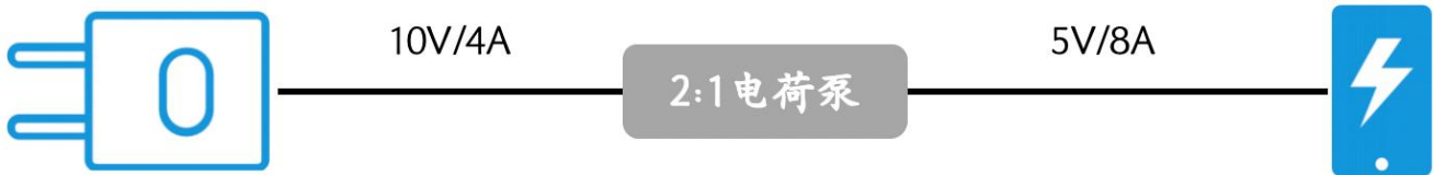
图表 31: 电荷泵快充方案可以使输出电压倍减、输出电流倍增 (图中为 40W 快充方案示意图)
