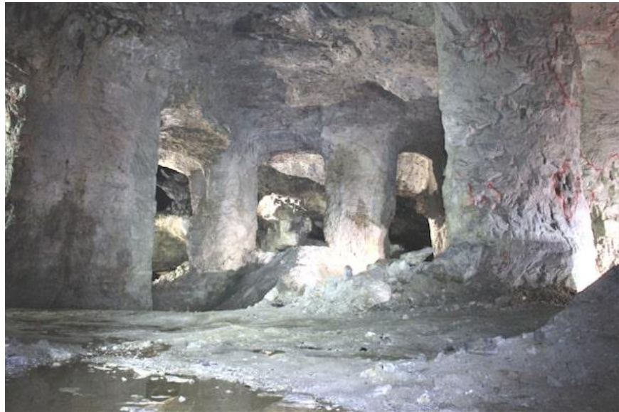
图表35: 项目采用房柱法, 矿柱中蕴含大量待采资源
