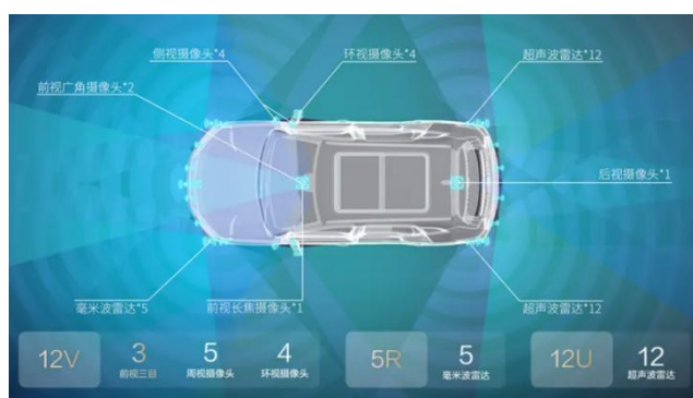
图 45: 比亚迪天神之眼 C 方案搭载 5 个毫米波雷达
