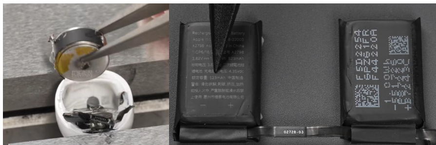
图表：AirPods Pro 2电池示意图
