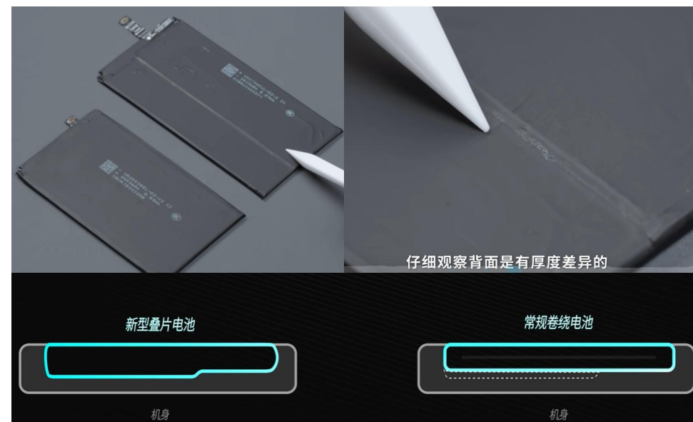
图表：MIX Fold 4的大电池采用异形电池设计
