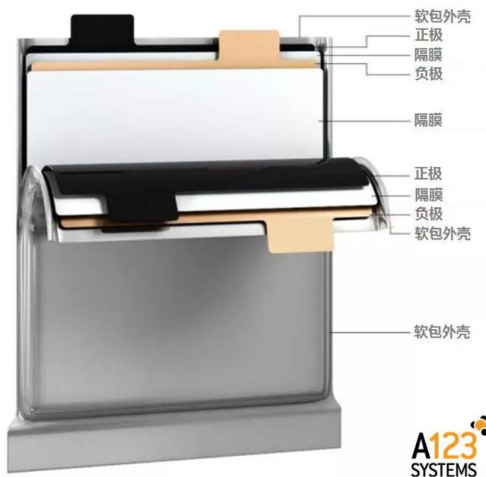
图表：软包锂离子电芯拆解示意图
