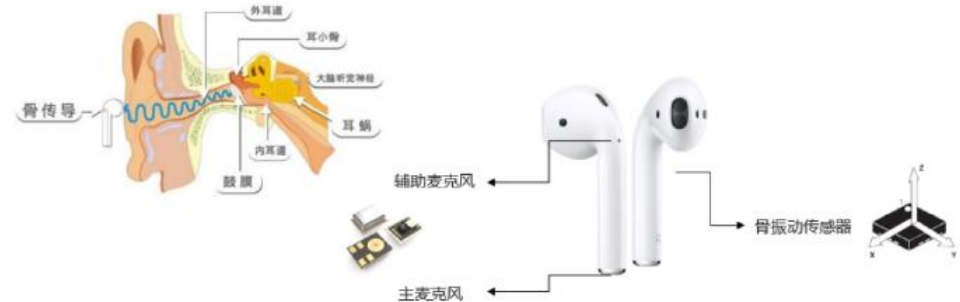
图 38: 骨震动传感器的检测原理
