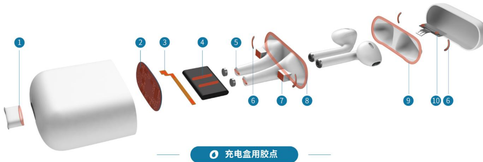
图表：TWS耳机充电盒用胶点示意
