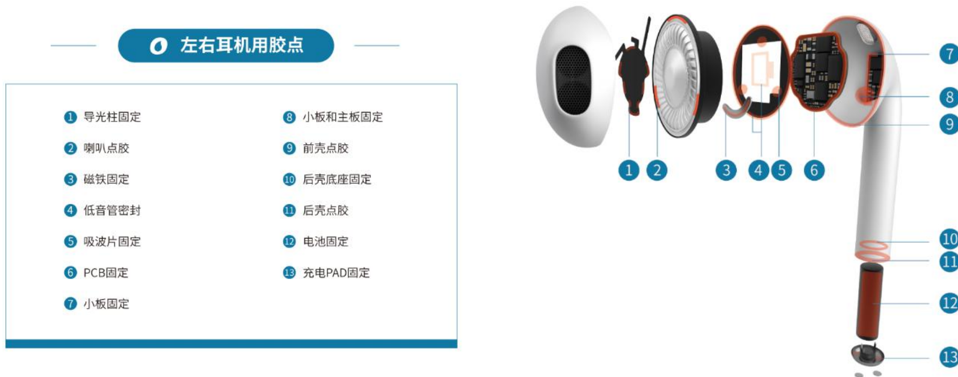
图表：TWS左耳耳机用胶点示意
