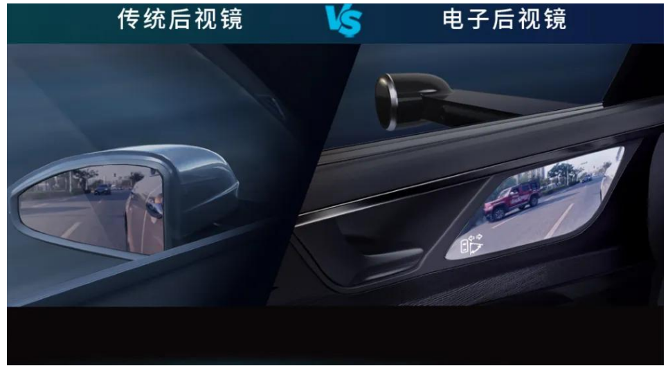
图 22: 相较传统后视镜, 电子后视镜视野盲区大大减少
