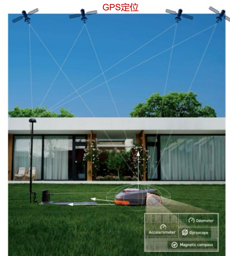
多种传感器：惯性导航、里程计、地磁信息、差分气压等
