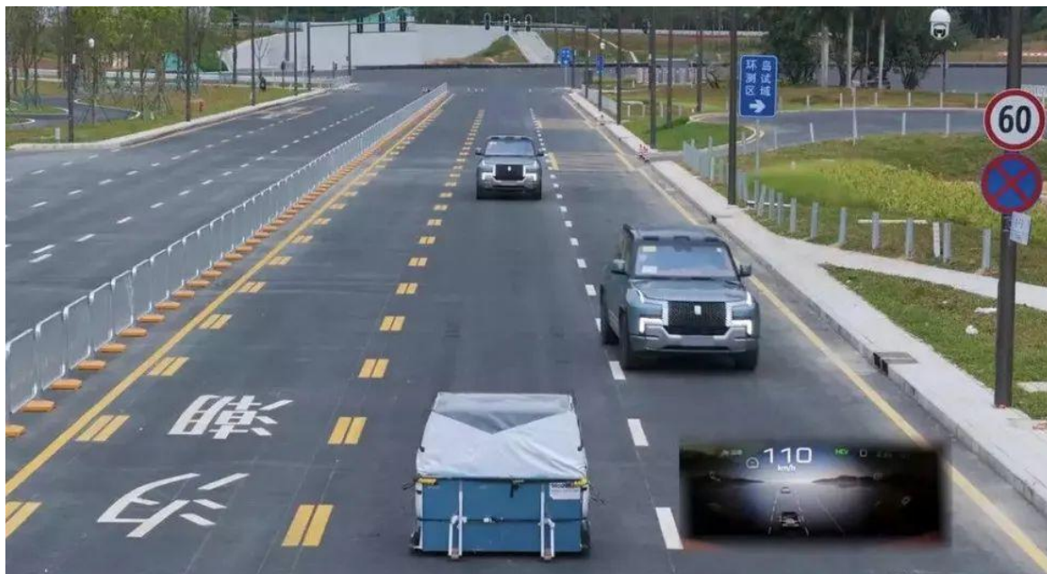
图 7: AEB 自动紧急刹车系统
