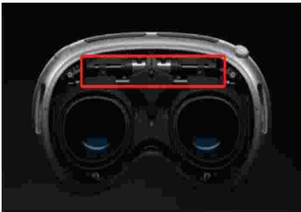
Vision pro配置了两组独立的瞳距调节系统
