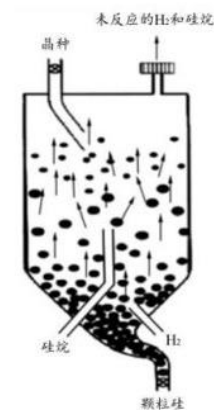
图19. 硅烷流化床法制备多晶硅
