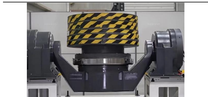
图75. 公司直驱转台产品示意图
