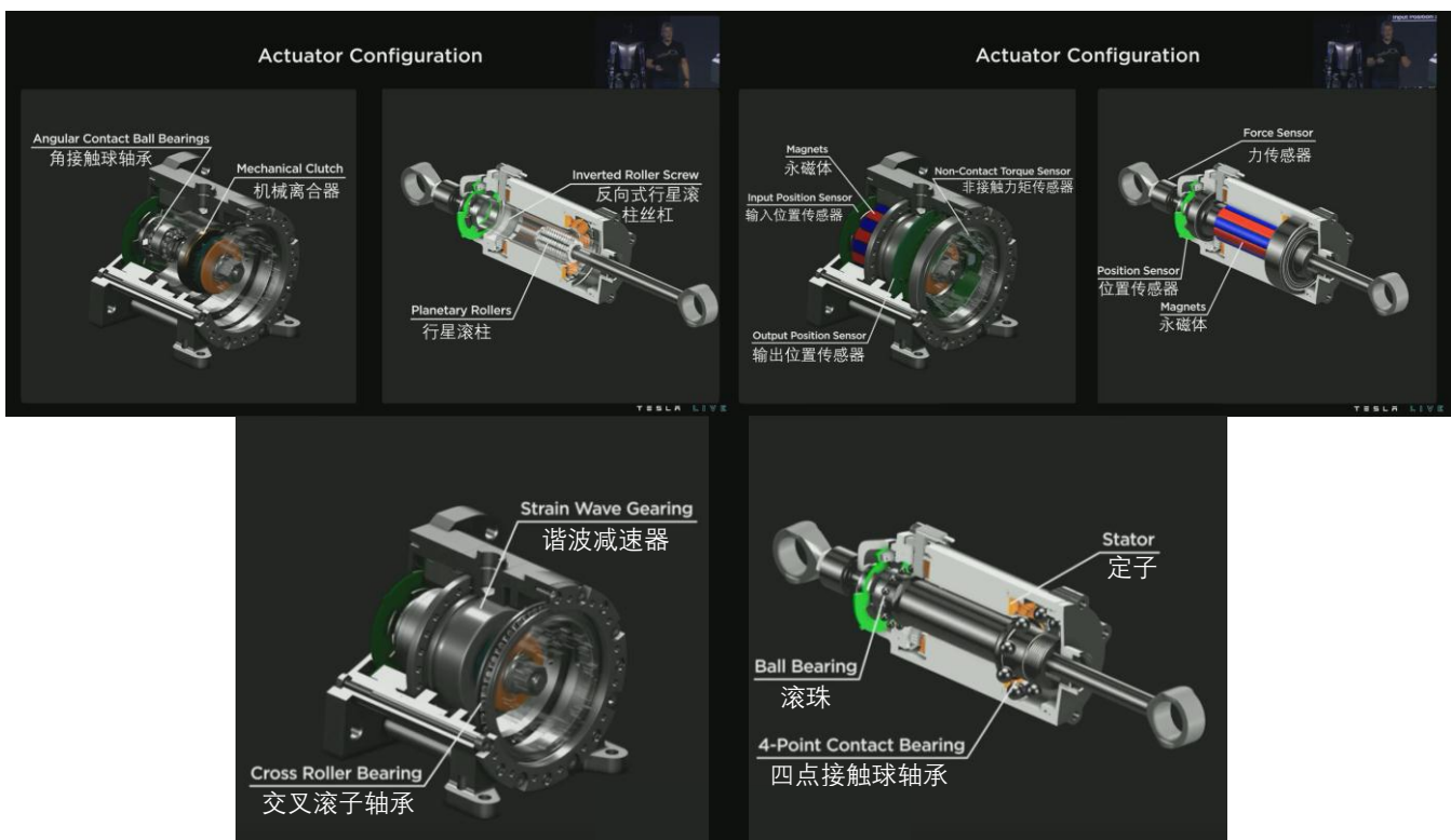
图 28：人形机器人不同执行器零部件构成情况
