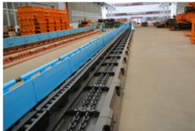
图表：矿用圆环链是刮板输送机的关键部件
