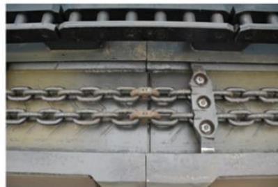
图表：矿用圆环链是刮板输送机的关键部件
