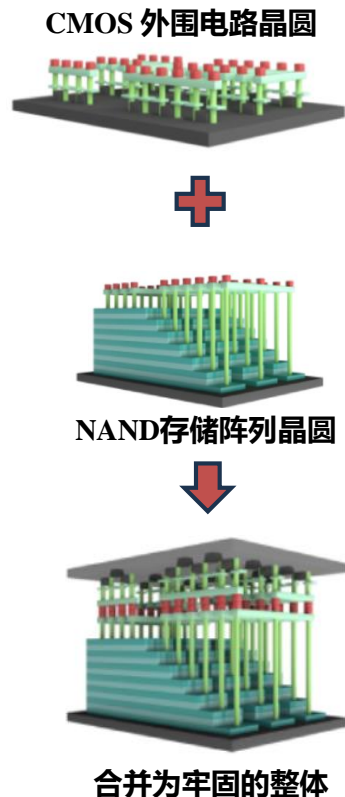
图：长江存储Xtacking技术采用晶圆键合工艺
