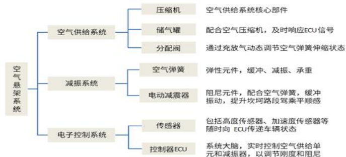
图 2-6：空气悬架系统各部件功能图
