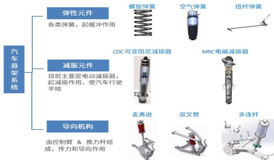
图 24：悬架系统构造图
