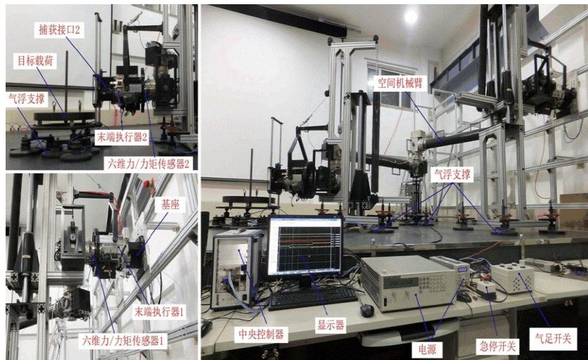
图：地面在线标定六维力/力矩传感器的实验系统
