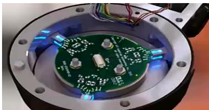
图：ATI六维力传感器的内部结构
