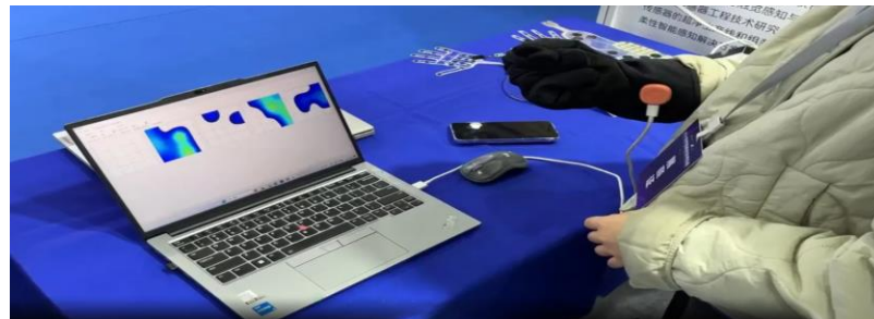
图：机器人灵巧手压力触觉检测系统
