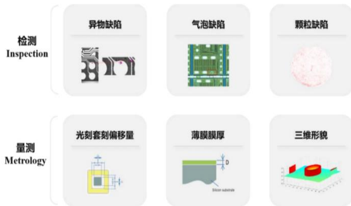
图：量/检测设备主要包括检测和量测设备两大类
