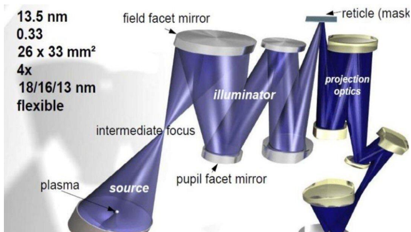
图表32：等离子体转换为波长13.5nm光的过程
