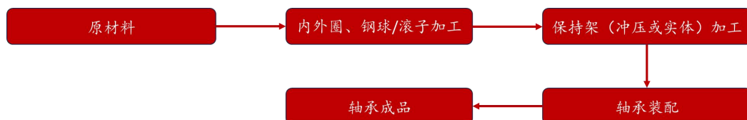
图表 25：轴承制造主要工艺流程
