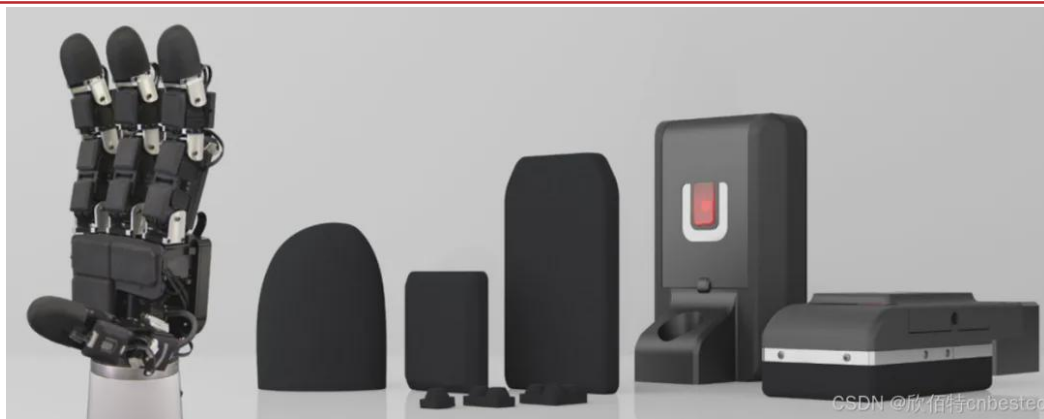
图表 48：机器人触觉感知目前形成 MEMS 传感器与电子皮肤两条主流路径
