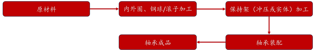
图表 25：轴承制造主要工艺流程
