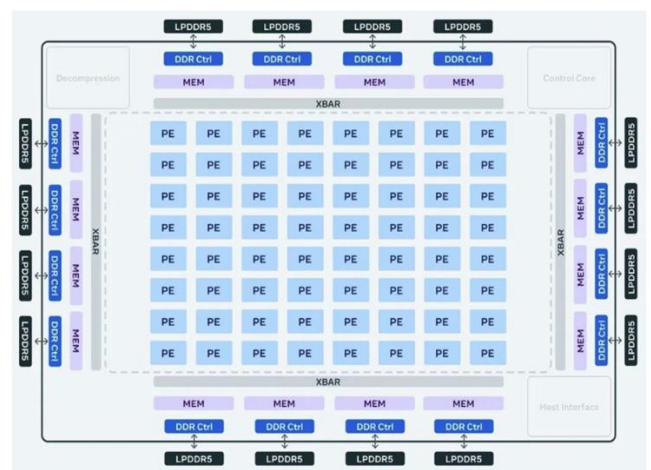
图表103：MTIA V2 芯片采用 8x8 处理元件 (PE) 布局
