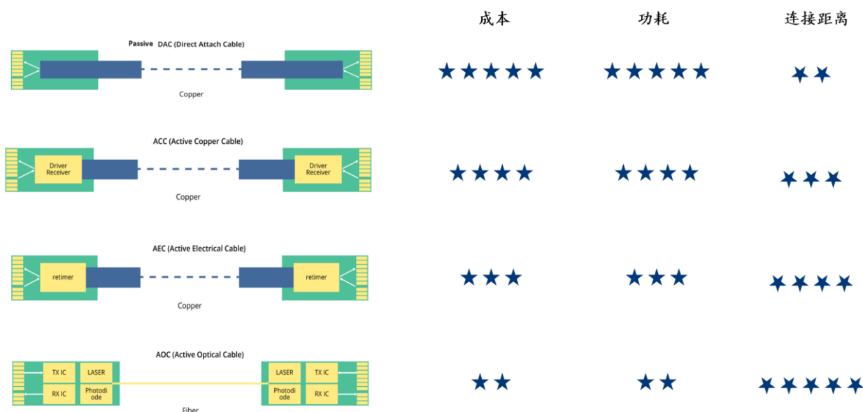
图表26: DAC、ACC、AEC、AOC 方案对比
