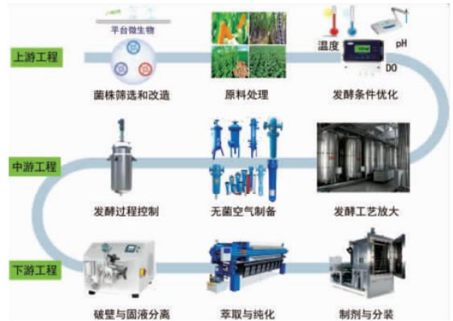
图表58：现代发酵放大工艺的流程示意图
