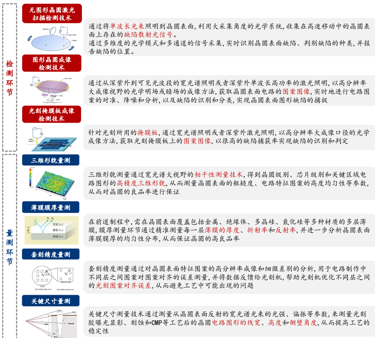
图表12：半导体光学检测的检测、量测技术分类
