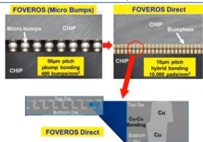
图表39：微凸点和混合键合横截面对比，混合键合无焊料球
