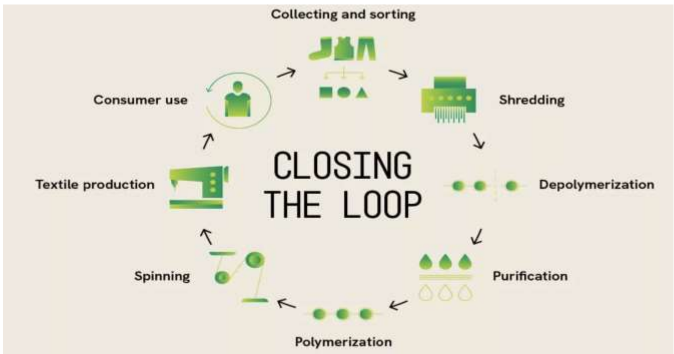
图表 51 loopamid 生产循环流程
