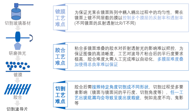
图表 26 阵列光波导制备过程及技术要点
