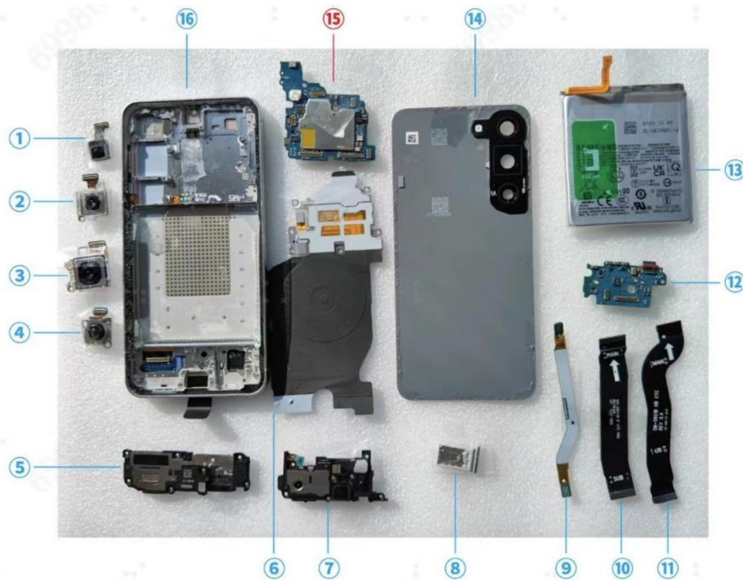
图表 23 三星 S24 内部拆解图
