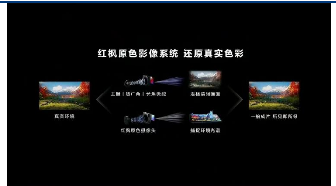
图表 30 多光谱摄像头通过捕捉环境光谱还原色彩
