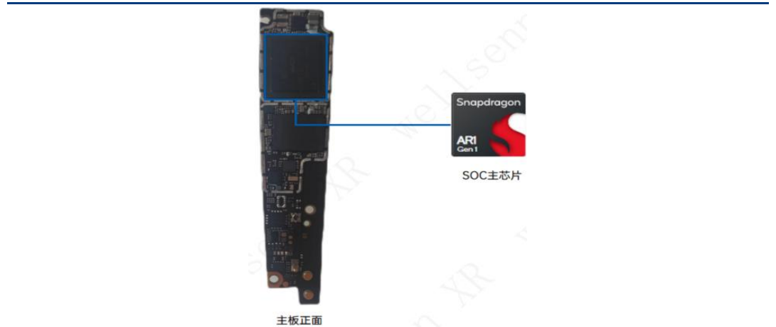
图表 27 Ray Ban Meta 采用 SoC 芯片——骁龙 AR1 Gen1
