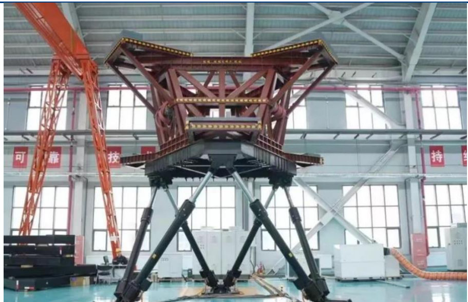
图表 41 摩诃创新自主研发的 14 吨六自由度全电运动平台
