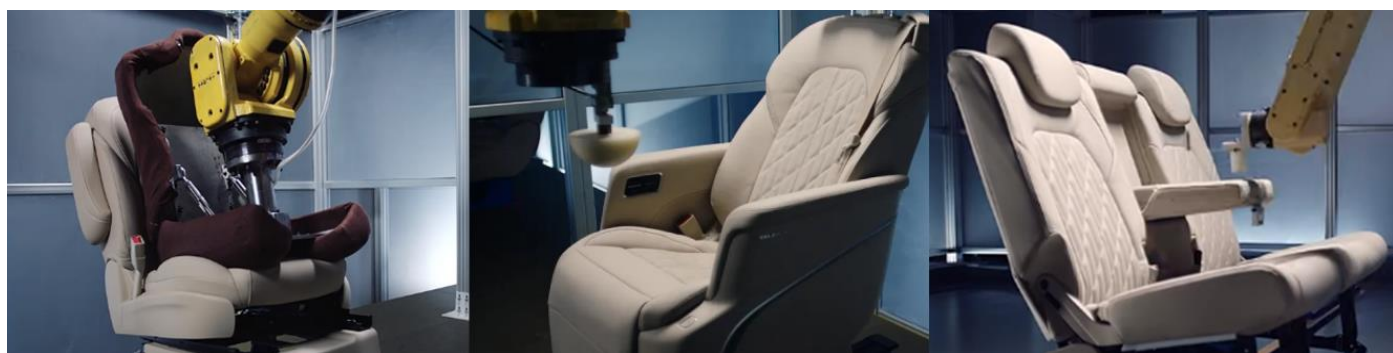
图表 20：别克 GL8 的导入导出试验、膝跪试验、扶手耐久试验
