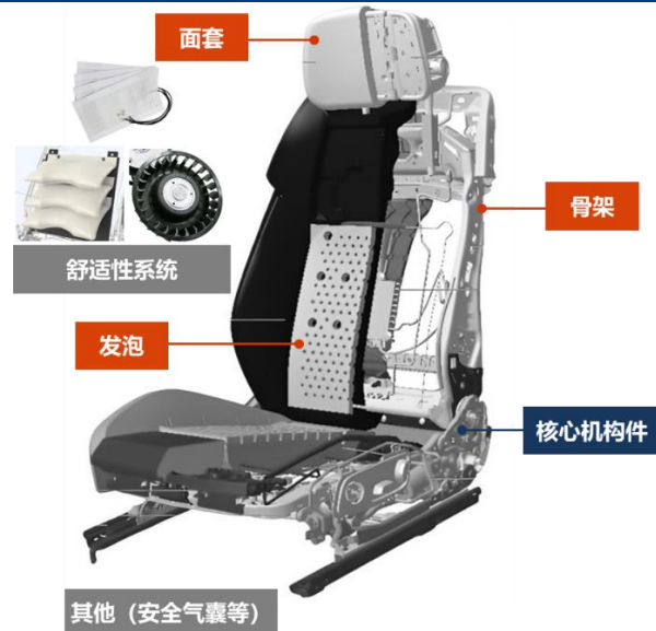
图表 11：汽车座椅核心部件拆解
