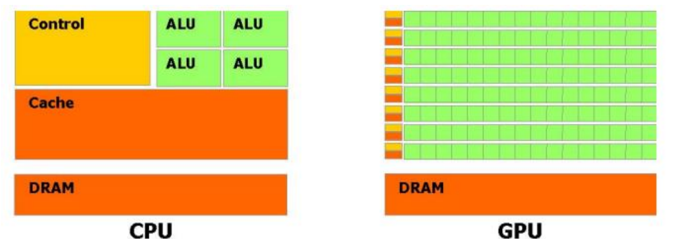
图表 7 CPU 和 GPU 的架构比较
