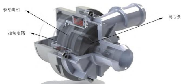
图表 20 电子水泵剖面效果图
