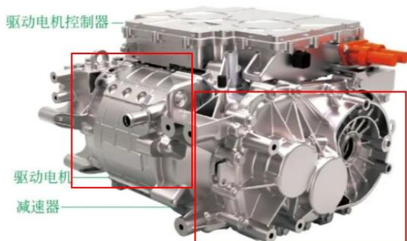
图表 23 新能源汽车减速器与电机结构
