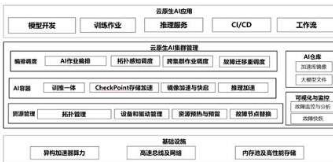
图 3-1-1 云原生 AI 技术架构
