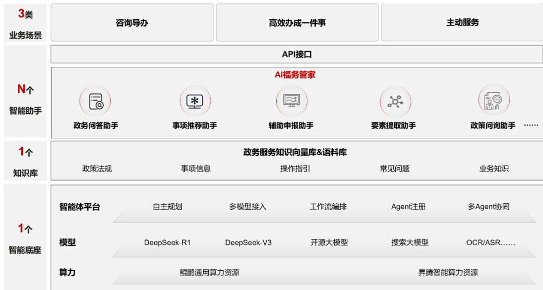
图 4-5 AI 福务管家解决方案整体架构图
