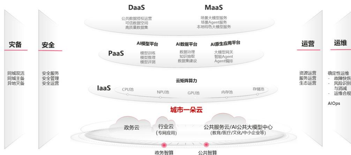
图 2-13 云设施逻辑架构图
