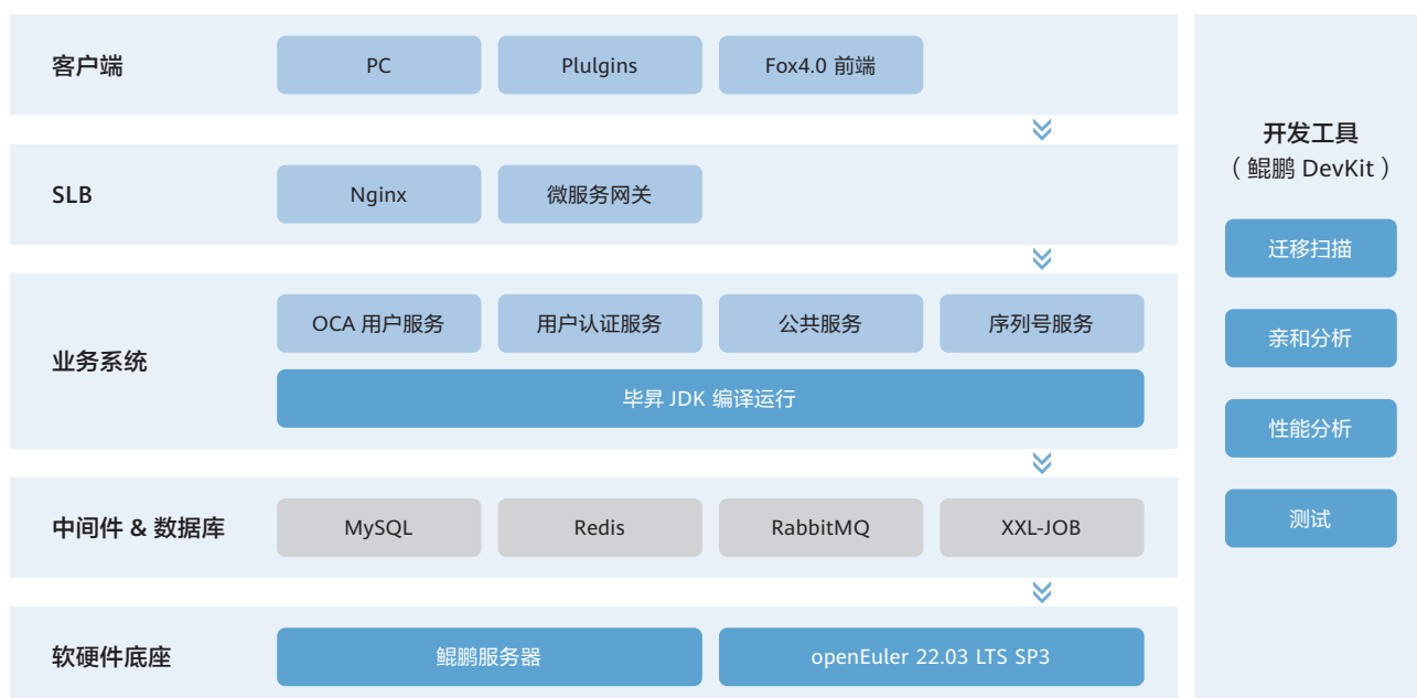
图 4-3 分布式企业网银系统 & 远程经营服务平台 鲲鹏原生架构图
