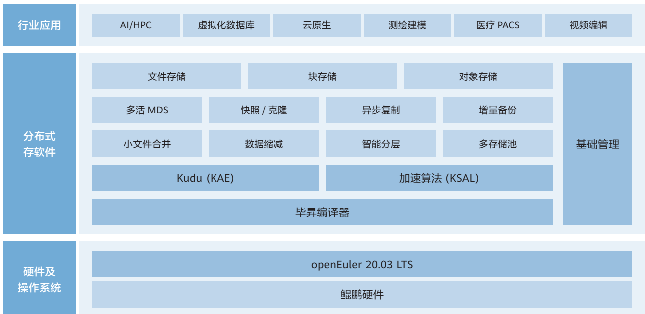
图 4-25 分布式存储 EDS 的鲲鹏原生架构图
