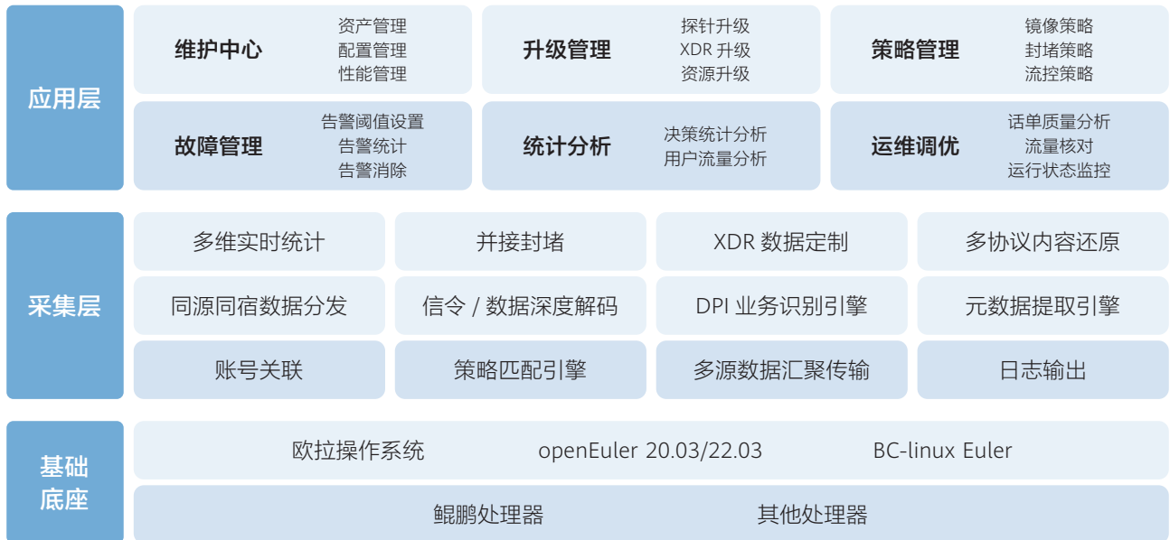
图 4-6 浩智睿一 DPI 采集系统架构图
