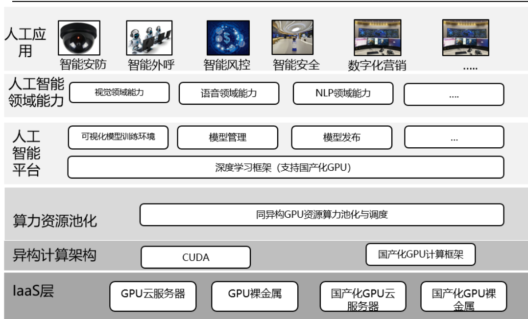
图 7 同异构 GPU 芯片的人工智能技术架构
