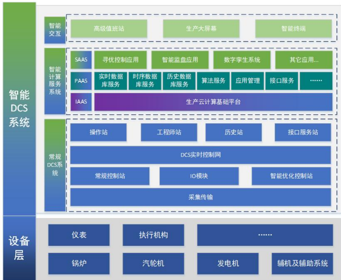
图 1 生产云平台技术架构
