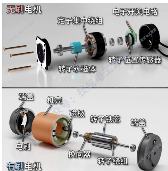
图 16：有刷直流电机和无刷直流电机的区别
