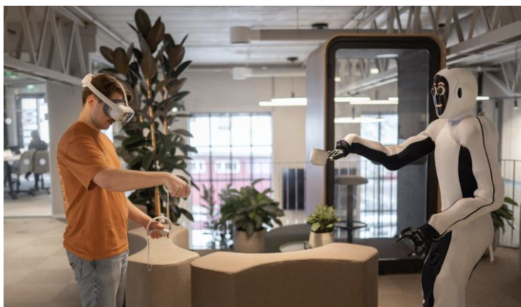
图24: 1X操作员通过VR Teleop训练机器人
