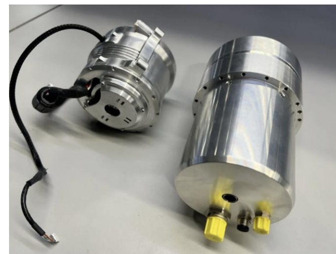
图34：Figure 自研的执行器（左） vs 具有相同扭矩的现成执行器（右）
