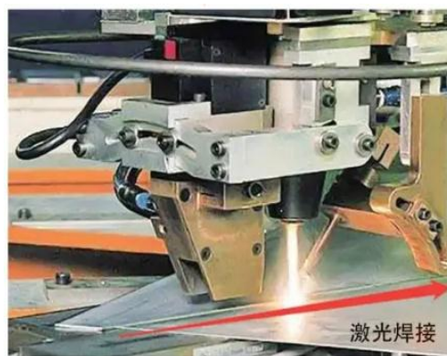
图 18: 激光焊接示意图
