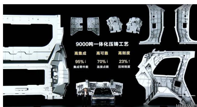
图 26：问界 M9 采用 9000T 一体化压铸工艺
