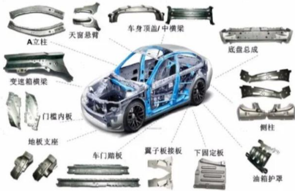
图 9：部分汽车冲压零部件示意图
