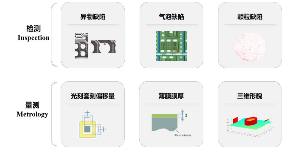
图 14：半导体检测与量测技术在芯片制造工艺中的具体应用
