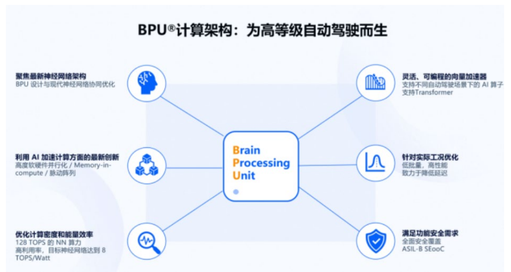
图 33：针对高等级自动驾驶而设计的 BPU 架构
